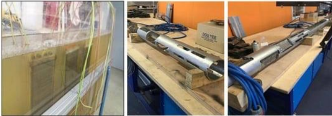
Abbildung 3. Laborprüfung von Ultraschallsendern (SONIC Technologies, GmbH, Sailauf, Deutschland).
